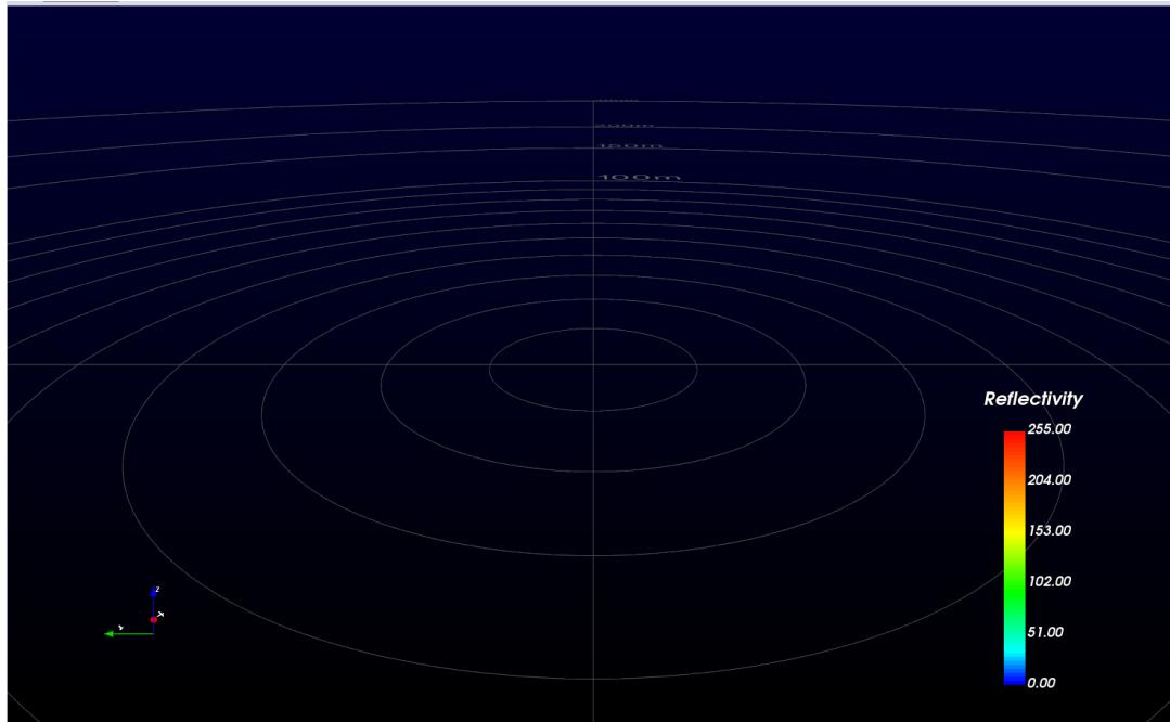
当设备连上 Livox Viewer，并且开始工作后，可于点云显示界面查看点云图。点云显示界面左下角为参考坐标，用户可通过该坐标了解当前被测物的坐标位置信息。右侧为反射率参考，可通过颜色来确定当前被摄物的反射率。
