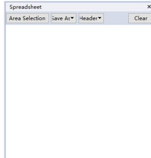
Area Selection: 启动框选，点击之后点云视图中鼠标会变为十字状，按下鼠标左键同时拖动鼠标可以对数据进行框选，框选出的内容将显示在该界面下方空白处，以表格的形式呈现：
