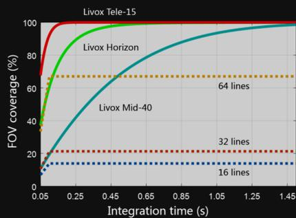
图 3：Livox 激光雷达 Mid-40、Horizon 及 Tele-15与采用多线机械旋转重复扫描方式的 64 线产品、32 线产品和 16 线产品的视场覆盖率对比（计算时视场被划分成 5mrad\*5mrad 的网格）
